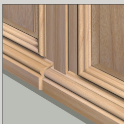
Battement central et jet d'eau porte d'entrée.
